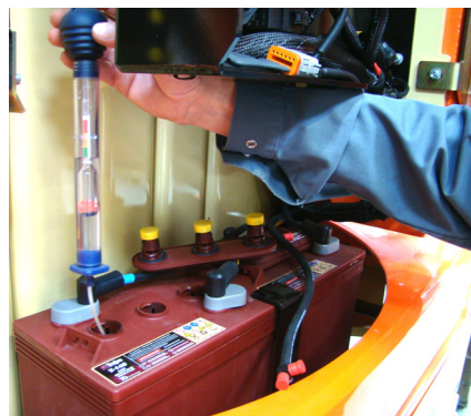
Figura 5-8. Medición de la gravedad específica del electrolito
